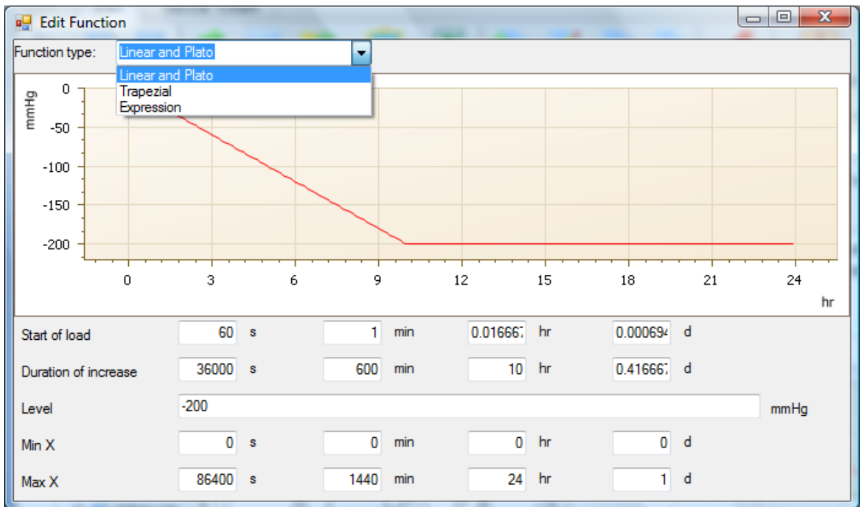
Рис. А.5. Вікно налаштування функції зовнішнього навантаження
